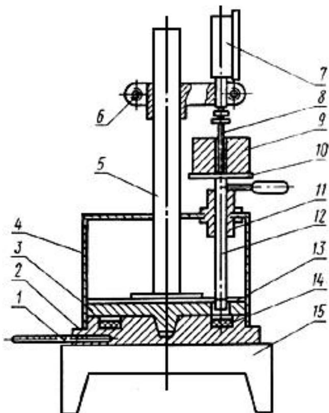
1 - термометр; 2 - нижняя плита; 3 - верхняя плита; 4 - кожух; 5 - стойка; 6 - держатель индикаторов;
